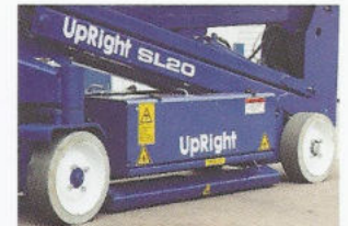
Das hydraulische Schlaglockschutzsystem wird bei Anheben der Hebebühne aktiviert.
